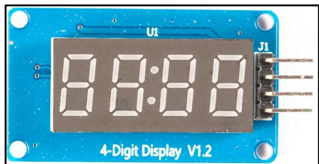
Abbildung 22: eigene Darstellung 7 Segmentanzeige
